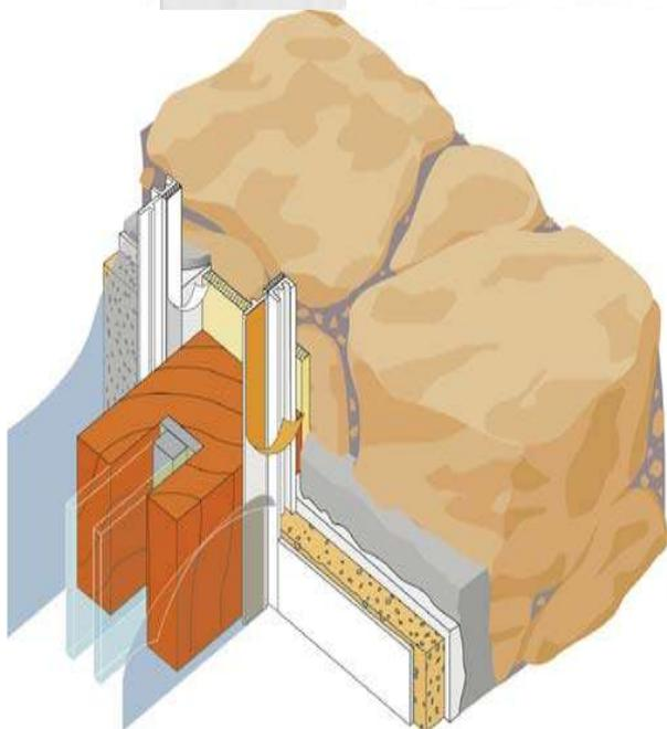
**Auf das Fensterelement wird das spezielle Anputzprofil aufgeklebt.**
